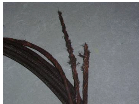
図3 ロープA、B破断部
